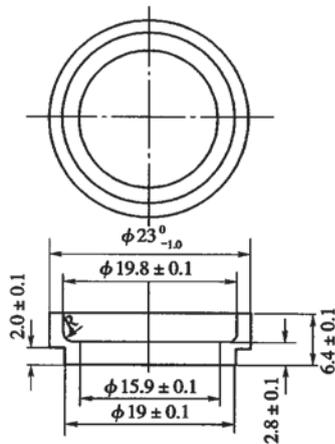
图 T 0606-2 试样环(尺寸单位:mm)
