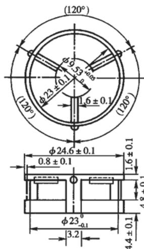
图 T 0606-3 钢球定位环(尺寸单位:mm)
