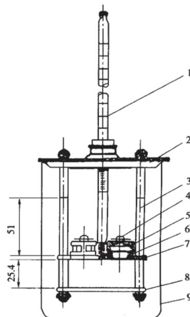
图 T 0606-1 软化点试验仪
